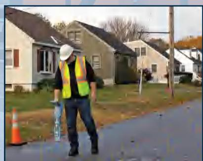
Повреждения оболочки кабеля можно обнаружить с точностью до 10 см при использовании режима поиска неисправностей на частоте 8 кГц с А-рамкой от Radiodetection.
